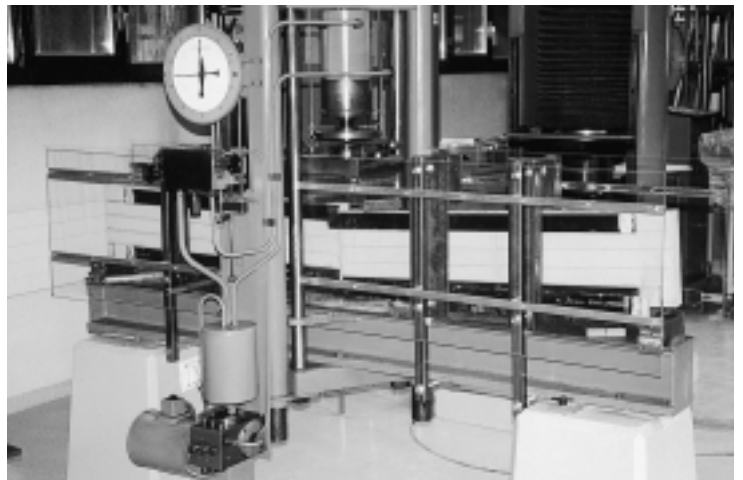
Vorversuche: Mit vorgespannten CFK-Lamellen zusammengehaltene GFK-Profile nach dem Bruch unter der Biegemaschine.
