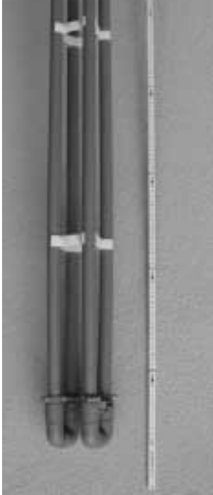
Abb. 3 Doppel U-Wärmetauscher aus Polyputenrohren. Einbau üblicherweise in ein Bohrloch, Hinter- füllung mit Zement- Bentonit-Gemisch
