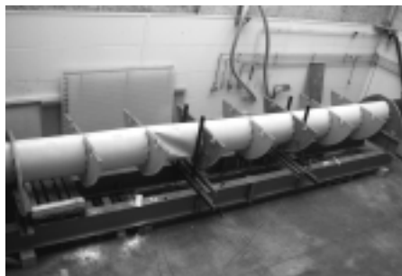
Biegezugversuch mit Beule
