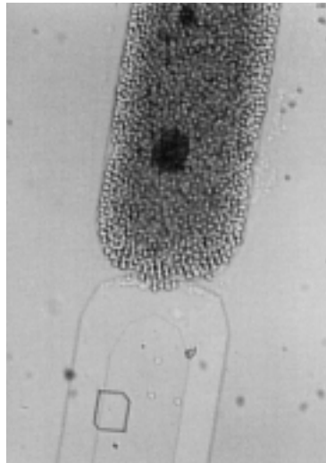
Abb. 5 Ein 0.1 mm breiter und 0.05 mm tiefer Mikrokanal mit Barriere. Der Teil oberhalb der Barriere ist mit Kügelchen gefüllt, welche einen Durchmesser von 0.005 mm haben. Die Barriere ist durchlässig für Flüssigkeiten aber nicht für die Kügelchen. Deshalb befindet sich im Teil unterhalb der Barriere nur Flüssigkeit. 100fache Vergrößerung.
