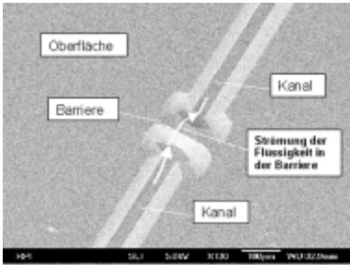
Abb. 4 Leerer, 0.05 mm breiter und 0.05 mm tiefer Mikrokanal mit einer für Flüssigkeit durchlässigen Barriere. In der Barriere sind zwei Öffnungen mit je 0.004 mm x 0.004 mm Querschnitt. 130fache Vergrößerung.
