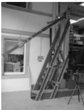
Energieabsorptionstest mittels Fallhammeranlage
