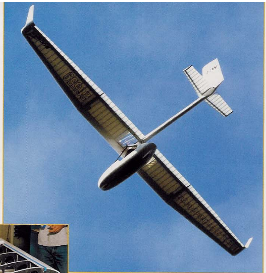
DER ARCHÄOPTERYX in seinem Element. Extremer Leichtbau ermöglicht Minimalgeschwindigkeiten von 30 km/h. Der Segler dreht dann mit einem Eigensinken von wenig mehr als 0,50 m/s.
