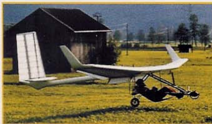
LANDUNG auf einen Hängegleiterplatz. Der Archäopteryx lässt sich extrem kurz landen. Ein großes Rad bildet mit einer kleinen Bugkufe das Fahrwerk.
